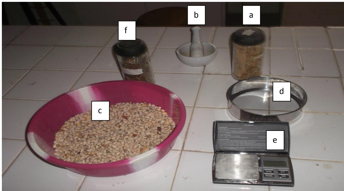
Planche 2 : Matériels de manipulation: (e) balance électronique, (d) tamis (0,4mm), (f) bocal contenant la poudre des feuilles. (c) récipient contenant les graines saines de niébé, (a) bocal contenant les poudres des racines, (b) mortier et le pilon.
