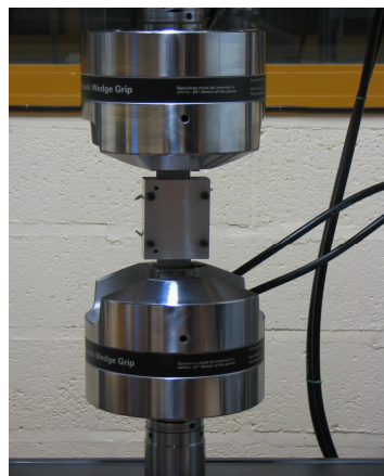
Figure 11 : Eprouvette équipée du raidisseur en place dans les mors hydrauliques de la machine au cours d'un essai de fatigue.
