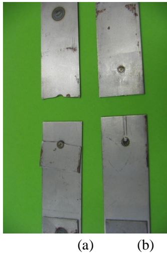
Figure 13 : Rupture (a) par fissuration, (b) par cisaillement d'une éprouvette soudée par point
