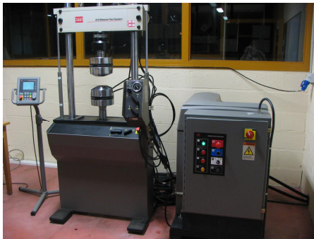
Figure 4 : Ensemble machine de fatigue et groupe hydraulique MTS
